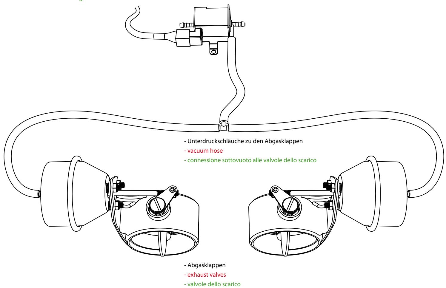
Anschlußschema mit neuer Steuerung (mit einem elektromagnetischen Umschaltventil)
